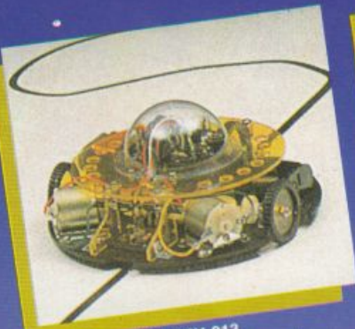
LINE TRACER II MV-913 Guidato da un sensore a raggi infrarossi questo robot segue qualsiasi linea nera tracciata su un foglio bianco.
